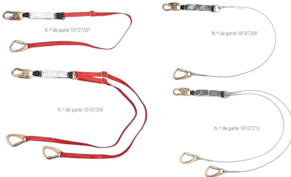
El confiable cordón absorbedor de energía con amortiguador FP5K Tie-Back emplea un mosquetón FP5K que puede engancharse directamente al cordón mismo. Este producto utiliza el absorbedor de energía Sure-Stop para mantener la fuerza de detención de la caída por debajo de los límites establecidos por ANSI, OSHA y CSA. La forma exclusiva del mosquetón impide que se confunda con conectores estándar no diseñados para aplicaciones con amortiguación Tie-Back.
